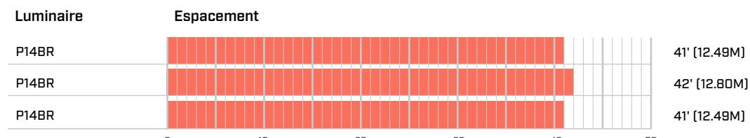
Espacement moyen de 1 luminaire sur 4 normalement allumé dans le chemin de sortie à des hauteurs de montage de 8, 10 ou 12 pieds
