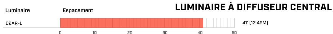
Espacement moyen de 1 luminaire sur 4 normalement allumé dans le chemin de sortie à des hauteurs de montage de 8, 10 ou 12 pieds
