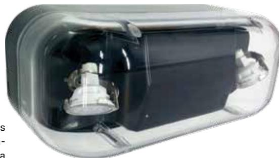
La série d'unités autonomes [à batterie] EBN est conçue en fonction des conditions d'environnement les plus extrêmes. L'unité, conçue à partir d'un boîtier en polycarbonate, conserve son intérieur scellé au moyen d'un joint d'étanchéité continu intégré. La série EBN se décline en versions de 6 VCC et 12 VCC, en capacité de 36 W, 50 W, 72 W, 100 W ou 130 W pour une autonomie minimale de 30 minutes en mode de secours. Autotest est standard.
