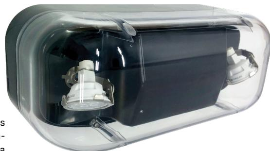
La série d'unités autonomes [à batterie] EBN est conçue en fonction des conditions d'environnement les plus extrêmes. L'unité, conçue à partir d'un boîtier en polycarbonate, conserve son intérieur scellé au moyen d'un joint d'étanchéité continu intégré. La série EBN se décline en versions de 6 VCC et 12 VCC, en capacité de 36 W, 50 W, 72 W, 100 W ou 130 W pour une autonomie minimale de 30 minutes en mode de secours. Autotest est standard.
