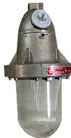
La série de phares satellites pour endroits dangereux RMHZ répond aux codes les plus stricts et procure une opération sûre et fiable. Les boîtiers de la série RMHZ sont faits d'aluminium sans cuivre moulé sous pression dans une variété de classes et divisions. Disponibles en modèles de 6V, 12V ou 24V avec montage au mur, plafond ou suspendu.
