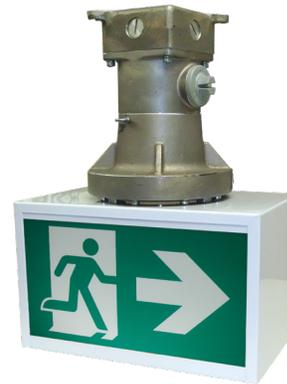
Les enseignes de sortie pour emplacements dangereux RPHZ sont conçues pour rencontrer et excéder les normes les plus exigeantes du code. Les boîtiers sont faits d'aluminium moulé sous pression robuste sans cuivre. Le boîtier et la plaque frontale sont faits d'acier robuste recouvert d'une couche de peinture en poudre blanche. Les enseignes peuvent être spécifiées pour s'adapter à une variété de montages, au plafond, au mur ou suspendu.
